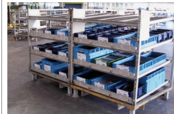
Ein Behältertransportgestell ermöglicht die sequenzgenaue Verbringung der Kleinteile
