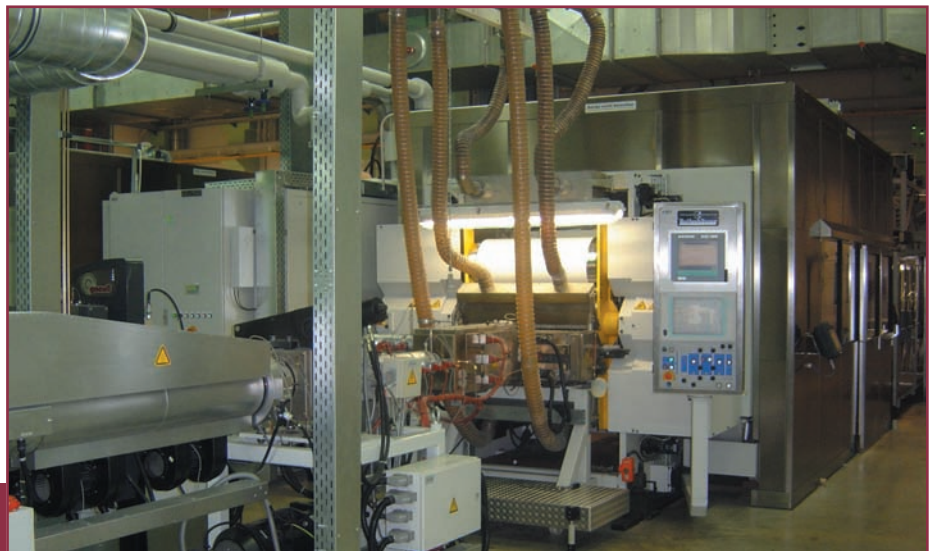
Bild 2: Plattenextruder mit Tiefziehmaschine für die Becherherstellung (Quelle: Optipack)
