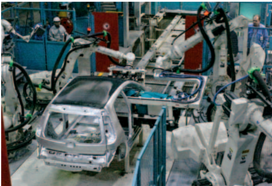
Fertigung des Smart Forfour im holländischen Born: Das Dachmodul ist kein Bestandteil des Rohbaus. Es wird von ArvinMeritor sequenzgenau ans Band geliefert.
